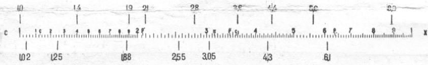
Пример:  $2 \times 2$ . Передвигаем движок вправо так, чтобы 1 на шкале *C* пришлась против 2 на шкале *D*. Установив визир против 2 на шкале *C*, читаем ответ (4) на шкале *D*.
