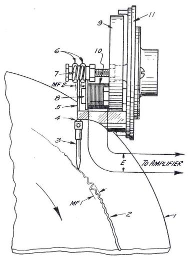
HOW THE ELECTRICAL PICK-UP WORKS
