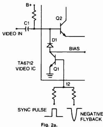
Fig. 2 — Blanking-level clamp.
