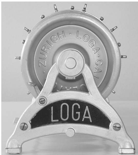
Fig. 3.10 Onderstel 15 m wals deels opengewerkt. opstaande kant met een fixeer rem. Letters goud op zwarte ondergrond
