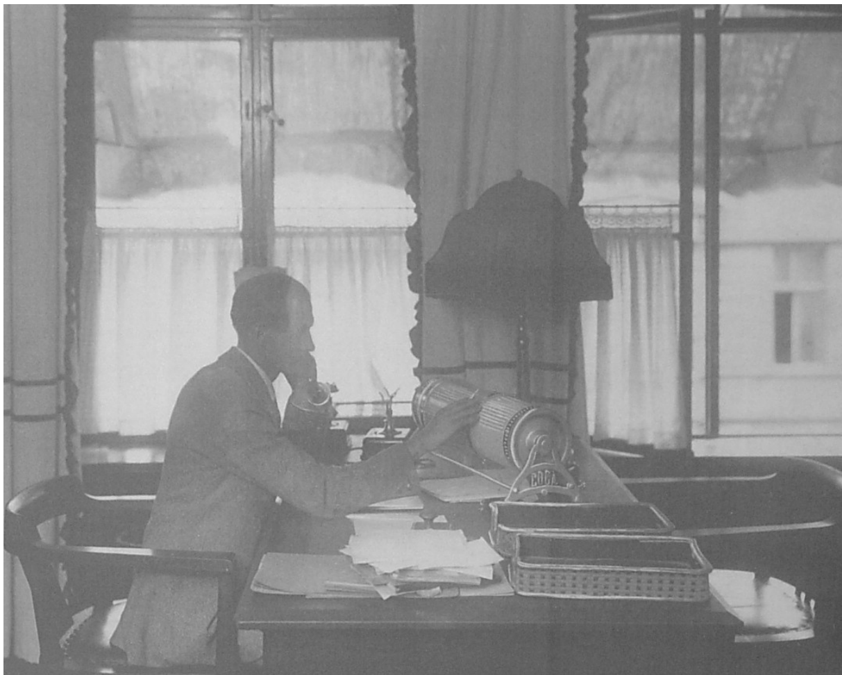
Fig. 7.3 Het gebruik van een LOGA rekenwals op een kantoor
